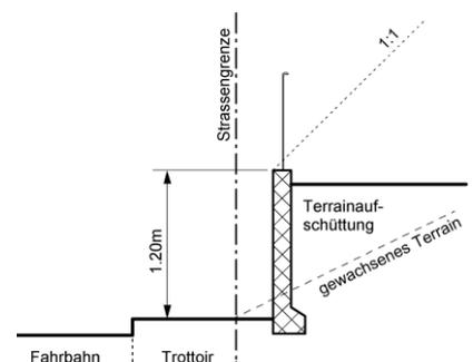
Diese Auslegung gilt auch für alle Arten von Böschungen (Böschungsteine, Steinquader, Steingitter etc.).
